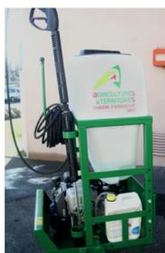
LAVOTOP est un kit de lavage mis au point par la Chambre d'agriculture du Gard. Il est composé d'une cuve de 100 ou 200 litres et d'une lance haute pression de 15 à 150 bars.
