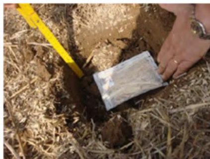
mise en place d'un LEVA-bag MD dans le sol
